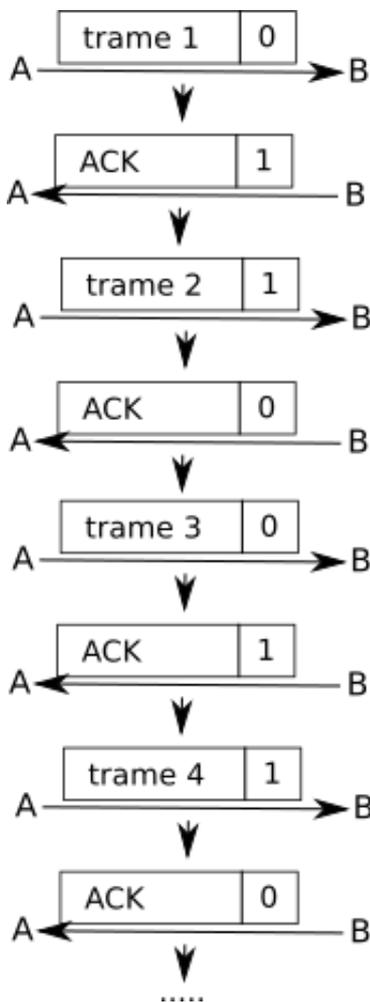
Le système de drapeau est complété avec un système d'horloge côté émetteur. Un "chronomètre" est déclenché à chaque envoi de trame, si au bout d'un certain temps, l'émetteur n'a pas reçu un accusé de réception correct (avec le bon drapeau), la trame précédemment envoyée par l'émetteur est considérée comme perdue et est de nouveau envoyée.
