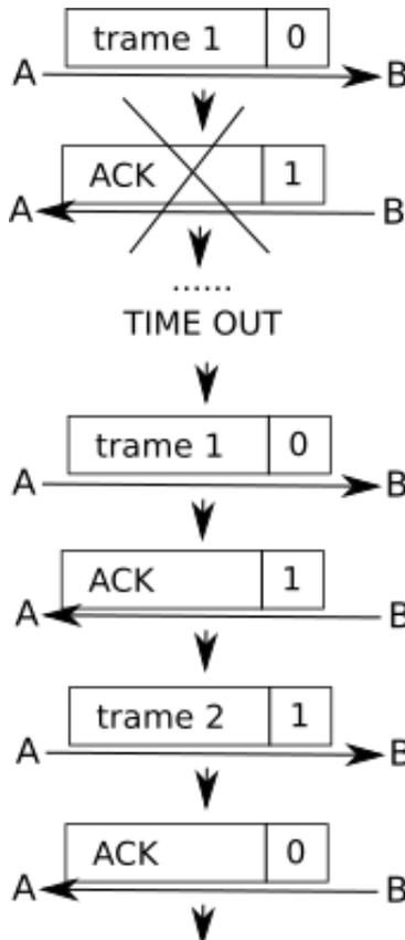
A ne reçoit pas d'accusé de réception avec le drapeau à 1, il renvoie donc la trame 1 avec le drapeau 0. B reçoit donc cette trame avec un drapeau à 0 alors qu'il attend une trame avec un drapeau à 1 (puisque'il a envoyé un accusé de réception avec un drapeau 1), il "en déduit" que l'accusé de réception précédent n'est pas arrivé à destination : il ne tient pas compte de la trame reçue et renvoie l'accusé de réception avec le
