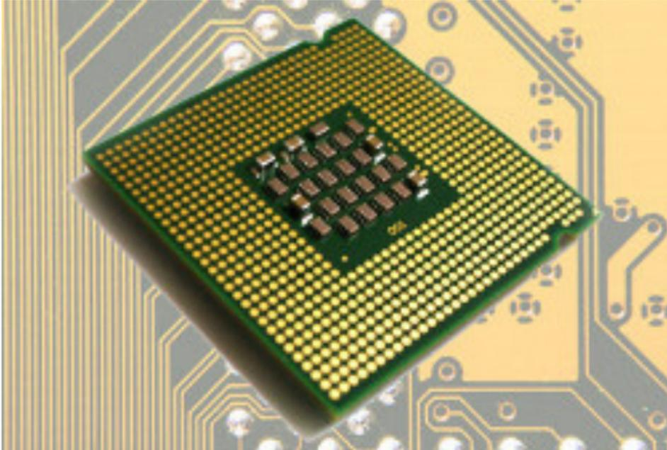
Le microprocesseur est le “cœur” d’un ordinateur : les instructions sont exécutées au niveau du CPU.
